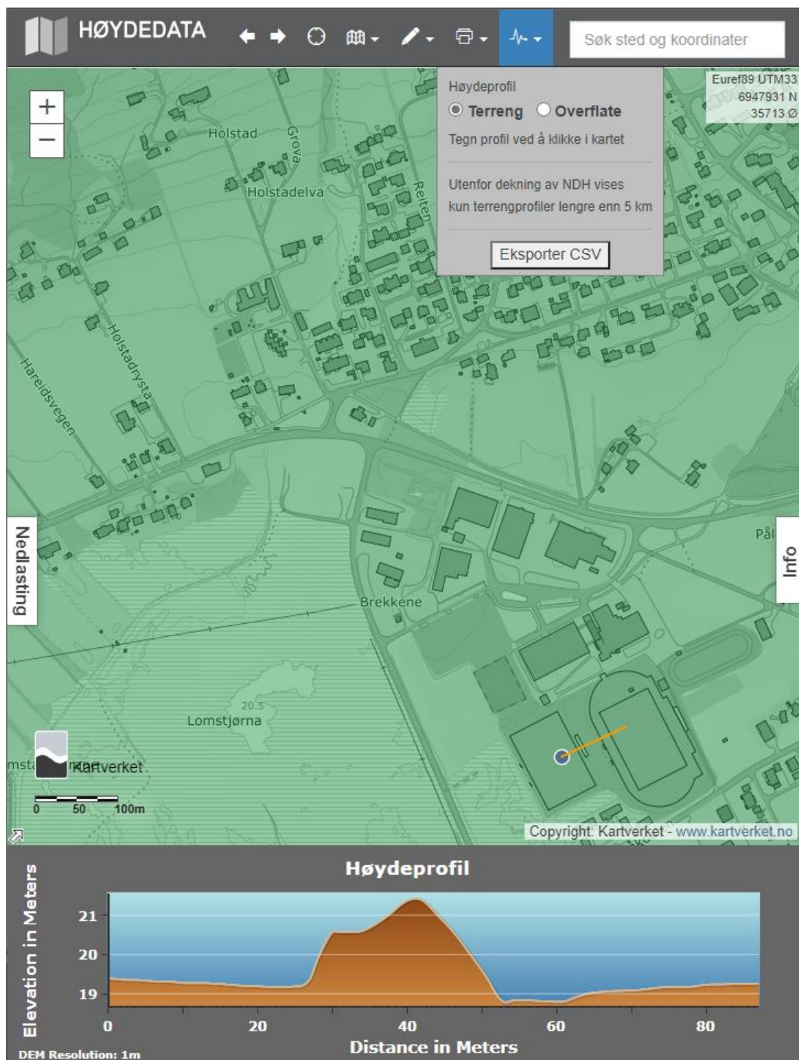
Profil 8: Presentasjon av Profil 8 fra høydedata.no [6]. Profilene strekker seg gjennom en forhøyning som kommer frem av bratthetskartet i NVE-atlas. Det er anses som overveiende sannsynlig at denne haugen er tilførte masser og ikke stedlige masser.
