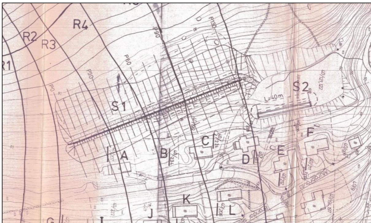
Figur 22: Utsnitt fra Figur nr. 3 som viser anbefalte sikringstiltak av NGI (NGI, 1989). Voll merket «S2» på figuren vurderes ikke lenger nødvendig på grunn av plantefelt i gran som i dag gir økt sikkerhet mot skred.
