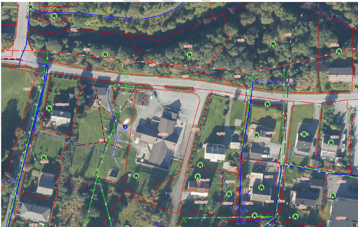
Figur 18 Foto som viser eksisterande leidningsnett; vassleidning (blå), spillvassleidning (grøn), avløpsleidning (stipla raud) og overvassleidning (stipla svart). Kjelde: Hareid kommune, kommunalteknikk
