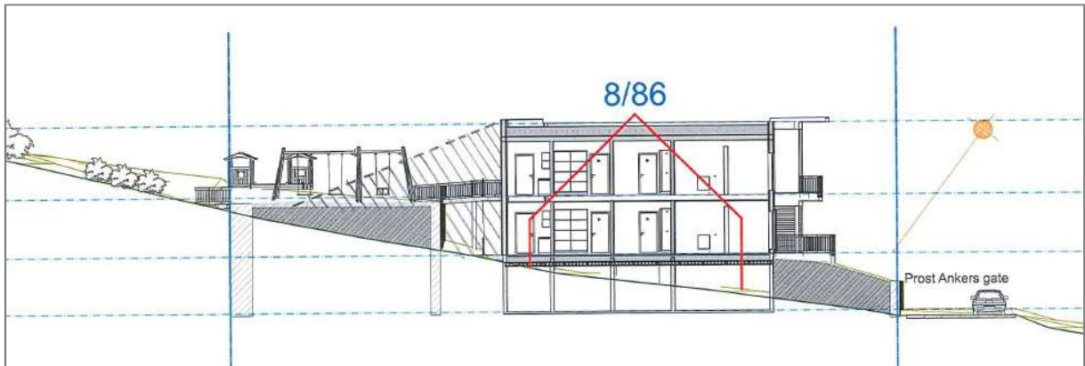
Skugge frå planlagde 4-mannsbustadar kl 15 vist på terrengsnitt A. Solvinkel i solretninga (jf. pil på ill.plan) er 23 grader.
